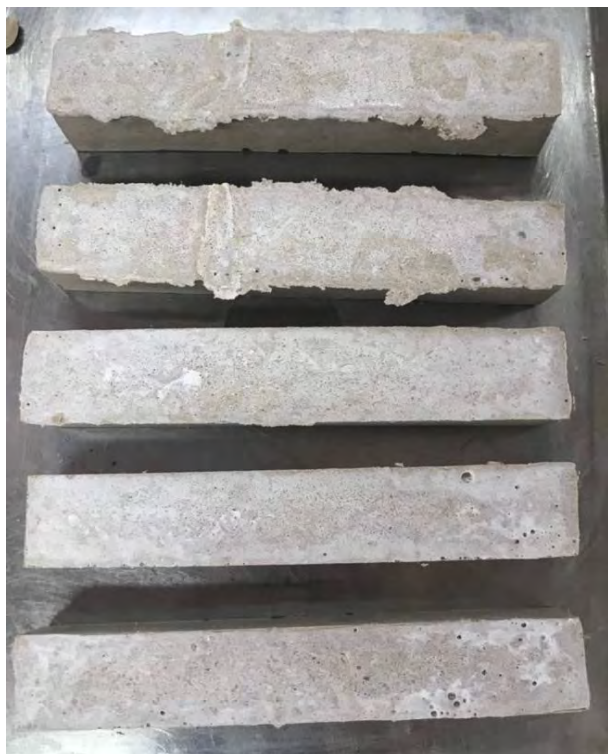
ภาพที่ 5 คอนกรีตทนไฟแมกนีเซียก่อนเผาสูตร C
