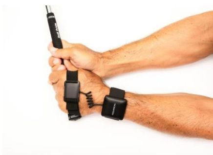
รูปที่ 8 ตำแหน่งการติดเซ็นเซอร์เพื่อวัดพิกัดการเคลื่อนไหวของข้อมือ
