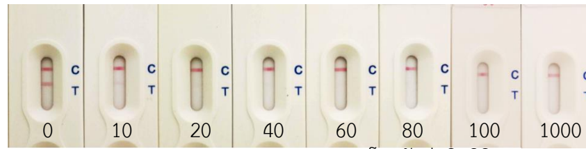
สารละลายมาตรฐาน CTC (นาโนกรัมต่อมิลลิลิตร)
