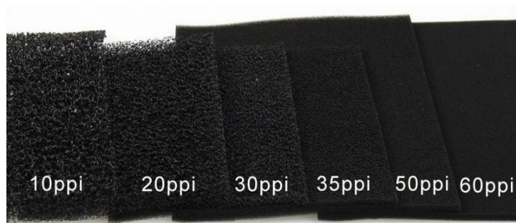
รูปที่ 2.11 ฟองน้ำพอลิยูรีเทนที่มีขนาดของรูพรุน 10 ถึง 60 PPI [4]
