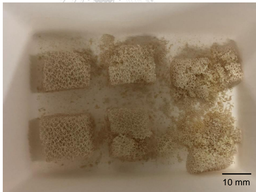
รูปที่ 4.4 ชิ้นงานหลังการเผาที่อุณหภูมิ 1300 องศาเซลเซียส
