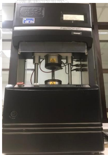
รูปที่ 3.5 เครื่องทดสอบลักษณะการคงรูปแบบไม่มีโรเตอร์
