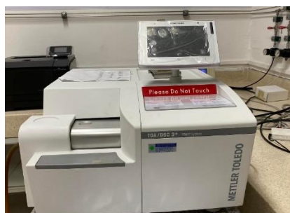
รูปที่ 3.10 เครื่องทดสอบการสลายตัวทางความร้อน
