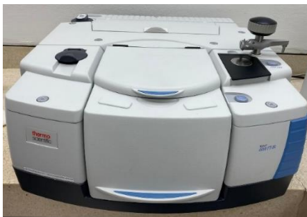
รูปที่ 3.7 เครื่องทดสอบฟูเรียร์ทรานสฟอร์มอินฟราเรดสเปกโตรมิเตอร์
