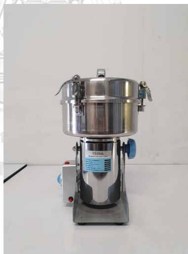
รูปที่ 3.2 เครื่องบดย่อยชีวมวลชนิดละเอียด
