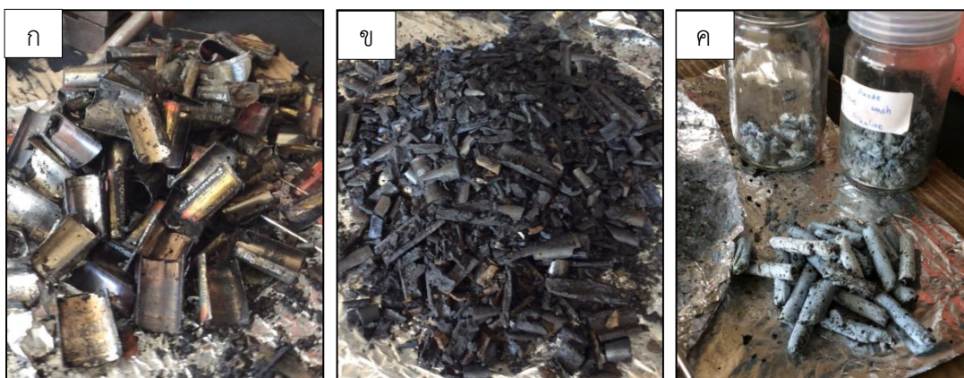
รูปที่ 4.1 ส่วนประกอบของแบตเตอรี่แอลคาไลน์ที่ผ่านการใช้งานแล้ว (ก) ปลาสติก, โลหะ, ตะปูเหล็ก และแผ่นกั้นขั้ว (ข) ซิงก์แมงกานีสออกไซด์และคาร์บอนที่เป็นขั้วแคโทด (ค) ซิงก์ออกไซด์ที่เป็นขั้วแอโนด
