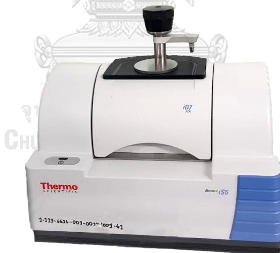
รูปที่ 3.6 ฟูเรียร์ทรานฟอร์มอินฟราเรดสเปกโตรมิเตอร์ รุ่น Nicolet iS5 จาก Thermo fisher
