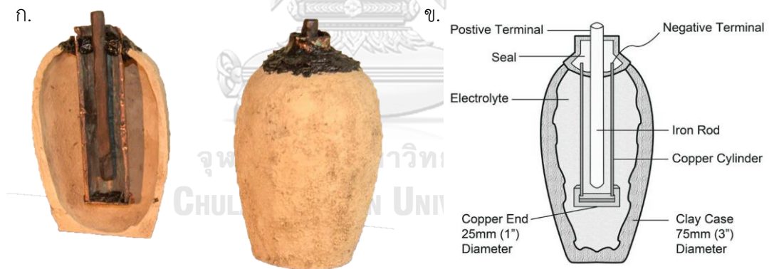
รูปที่ 2.1 (ก.) แบตเตอรี่พาร์เธียน (ข.) ส่วนประกอบของแบตเตอรี่พาร์เธียน [12]
