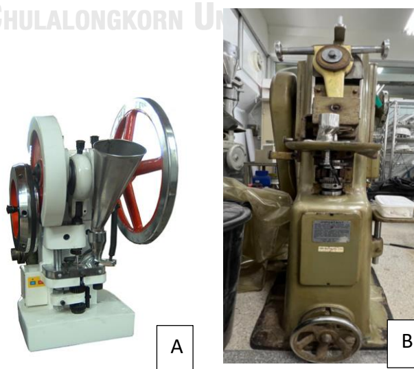
ภาพที่ 2.9 เครื่องตอกเม็ดยา (A) ชนิดสากเดี่ยว และ (B) ชนิดไฟฟ้า
