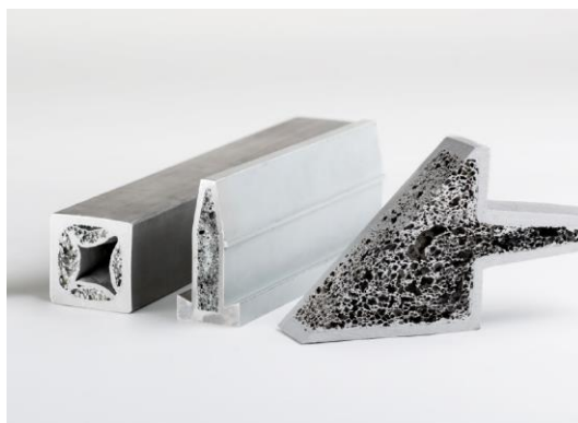
รูปที่ 2.3 วัสดุที่มีโฟมอะลูมิเนียมอยู่ภายในโครงสร้าง
