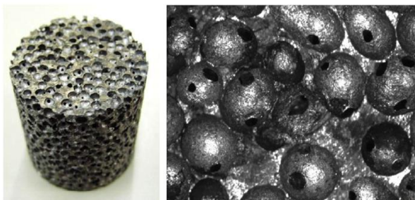
รูปที่ 2.17 ตัวอย่างโฟมอะลูมิเนียมที่ได้จากการผลิตโฟมโลหะโดยใช้ลูกบอลเกล็ดสร้างรูพรุน [13]
