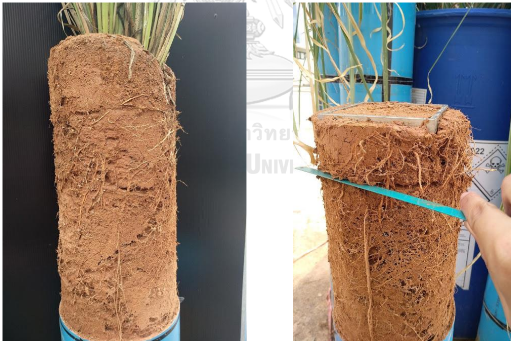
รูปที่ 24 ดินที่ปลูกหญ้าแฝกในท่อ PVC เพื่อทำการทดสอบกำลังรับแรงเฉือนโดยตรง
