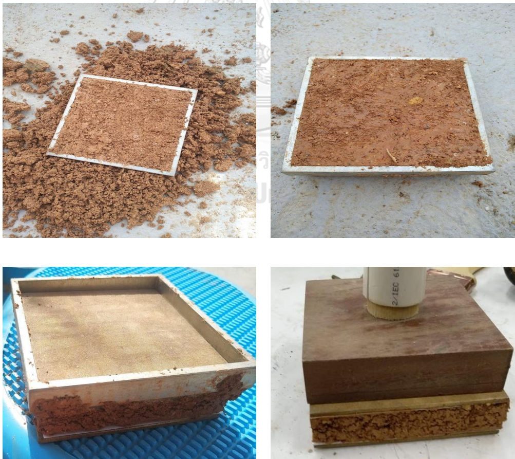
รูปที่ 26 ตัวอย่างดินที่ราก นำเข้าบรรจุในบล็อกทดสอบกำลังรับแรงเฉือน
