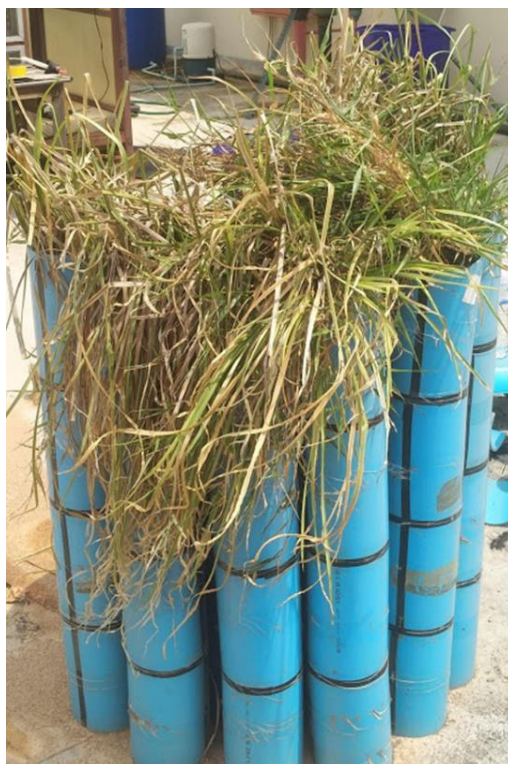
รูปที่ 22 การปลูกพืชในท่อ PVC สำหรับการทดสอบกำลังรับแรงเฉือนของดิน
