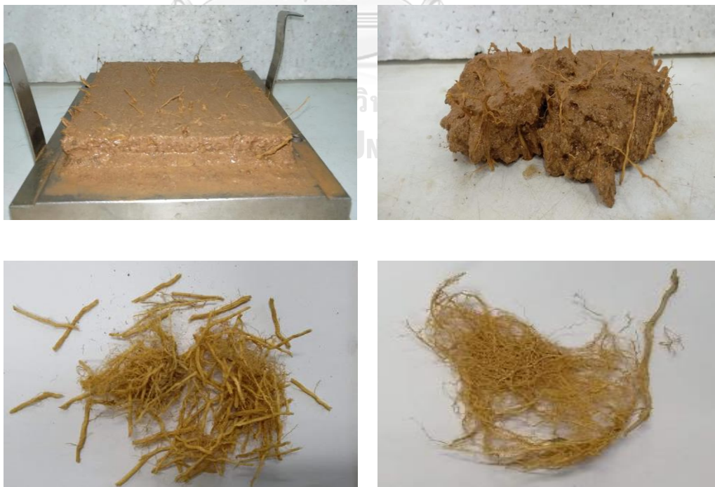
รูปที่ 28 หลังทำการทดสอบกำลังรับแรงเฉือน และแยกรากออกจากตัวอย่างดิน
