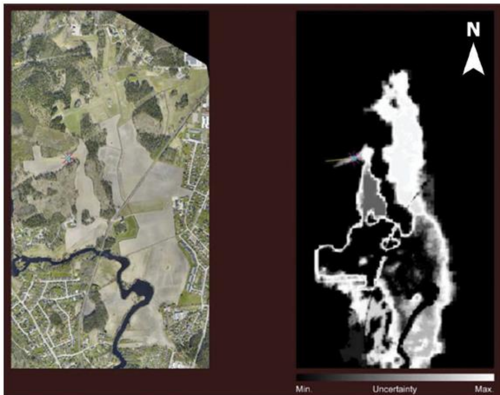
ภาพที่ 8 แผนที่ 2 มิติแสดงภาพถ่ายออร์โธ และความไม่แน่นอนของขอบเขตพื้นที่น้ำท่วม (Lim et al., 2016)
