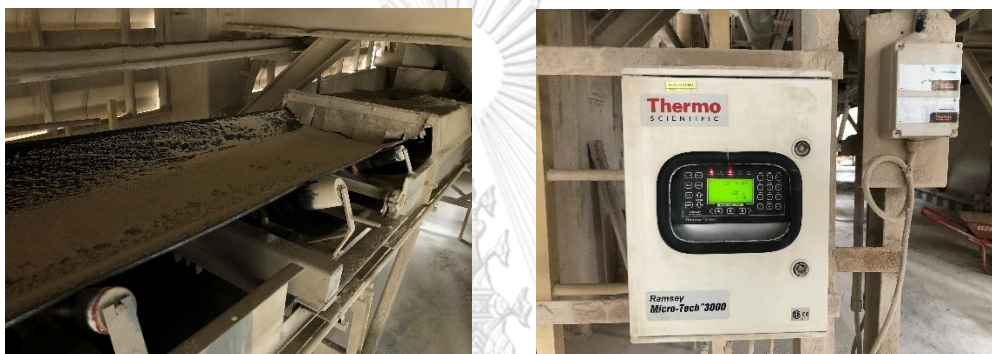
ภาพที่ 4.14 เครื่องชั่งแบบสายพานลำเลียง (Belt weigher) ที่ใช้อ่านค่าปริมาณทราย
