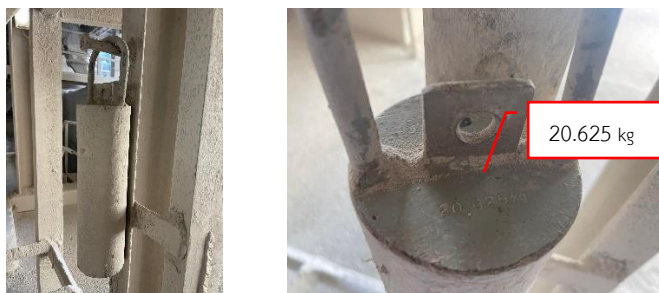
ภาพที่ 4.18 ต้มน้ำหนักมาตรฐานขนาด 20.625 กิโลกรัม
