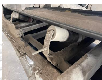
ภาพที่ 4.19 ตำแหน่งในการแขวนต้มน้ำหนักเพื่อสอบเทียบเครื่องชั่งแบบสายพาน
