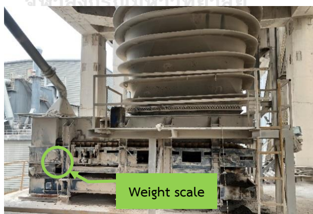
ภาพที่ 4.2 เครื่องชั่งน้ำหนักแบบสายพานลำเลียงที่ใช้ป้อนหินปูนเข้าเครื่องบด
