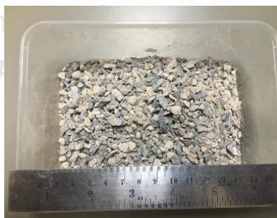
ภาพที่ 4.13 ตัวอย่างของหินปูนที่ใช้ในกระบวนการ
