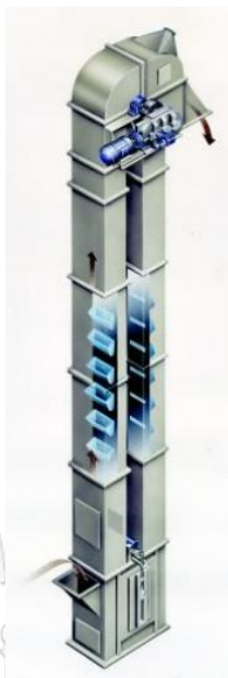
ภาพที่ 4.12 Recirculated Bucket Elevator
