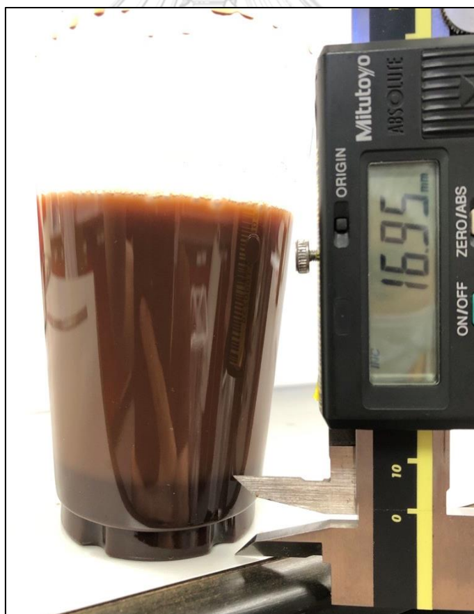
รูป 3-4 วิธีการวัดค่าความสูงของตะกอน
