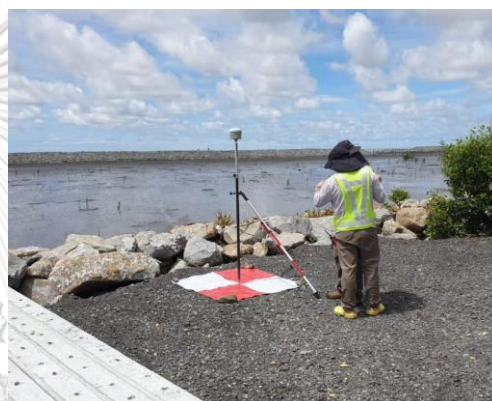
ก) การวางจุดตรวจสอบบนโครงสร้างที่ บ้านสีลัง ข) การวางจุดตรวจสอบบนพื้นดินที่ บ้านสีลัง รูป 3-23 ตัวอย่างการวางจุดควบคุมภาคพื้นดิน และจุดตรวจสอบ ที่บ้านสีลัง จ.ฉะเชิงเทรา
