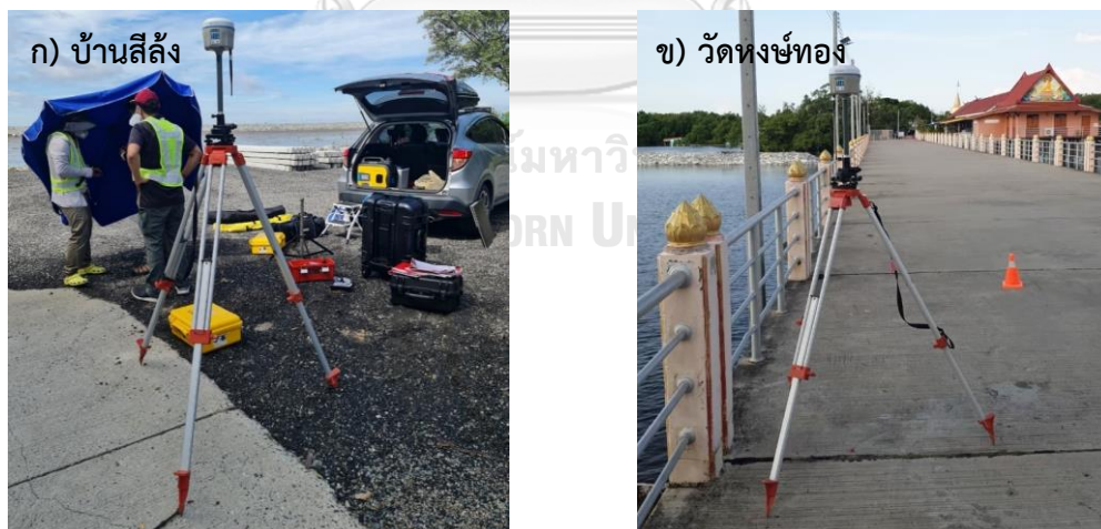
รูป 3-22 การวางตำแหน่งจุดอ้างอิงในพื้นที่สำรวจ
