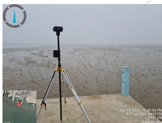
ก) การสำรวจระดับท้องทะเลในช่วงระดับน้ำลงต่ำสุด เพื่อให้ได้พื้นที่สำรวจขนาดใหญ่ขึ้น ข) การควบคุมโดรนจากระยะไกล
