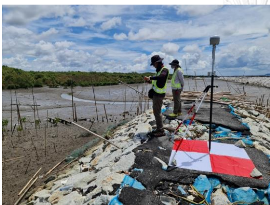
ก) การวางจุดตรวจสอบบนโครงสร้างที่ บ้านสีลัง ข) การวางจุดตรวจสอบบนพื้นดินที่ บ้านสีลัง รูป 3-23 ตัวอย่างการวางจุดควบคุมภาคพื้นดิน และจุดตรวจสอบ ที่บ้านสีลัง จ.ฉะเชิงเทรา
