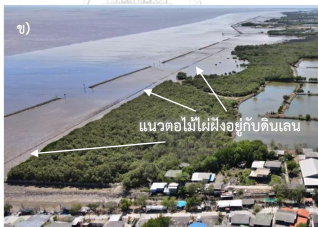
ข) แนวไม้ไผ่ชะลอคลื่นปี 2564 เหลือเพียงต่อไม้ไผ่ฝิ่งอยู่กับดินเลนที่ปากคลองตาก๊กฝิ่งตะวันตก รูป 5-6 แนวไม้ไผ่ส่วนที่หักและติดอยู่กับท้องน้ำที่บริเวณบ้านตาก๊กถึงบ้านตาเจ็ย
