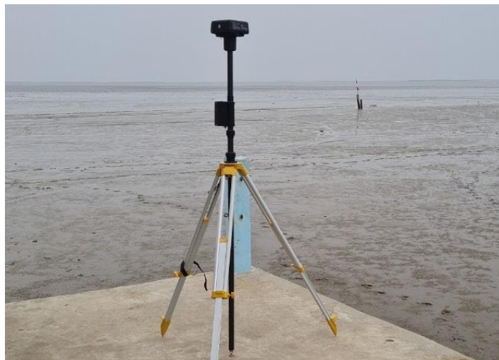
ค) เครื่องรับสัญญาณดาวเทียมสำหรับปรับแก้ตำแหน่งโดรนแบบจลน์
