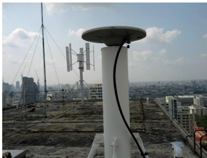
รูปที่ 1.1 สถานีฐานอ้างอิงแบบรับสัญญาณ GNSS แบบต่อเนื่อง CUUT (IGS, 2020)
