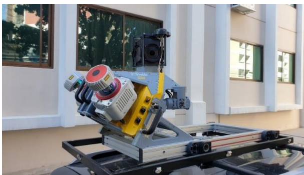
รูปที่ 1.2 ชุดระบบการทำแผนที่ชนิดเคลื่อนที่ ยี่ห้อ Trimble รุ่น MX9
