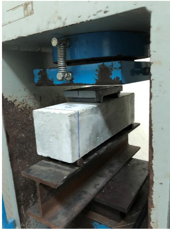
รูปที่ ค5 ทดสอบกำลังรับแรงดัดของคอนกรีต
