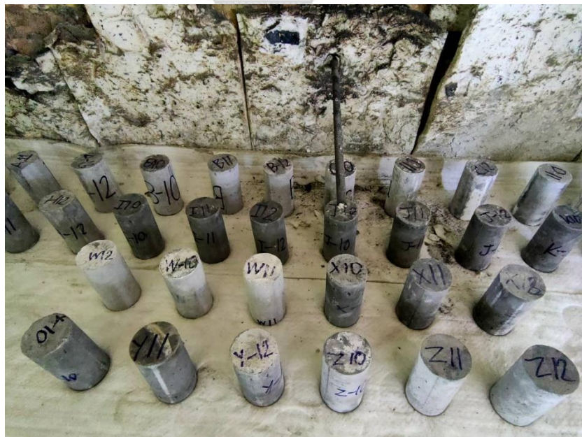
รูปที่ ค6 ทดสอบการทดสอบความทนทานของคอนกรีตในสภาวะเพลิงไหม้
