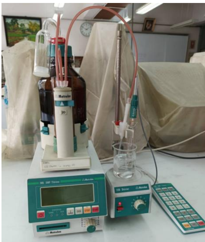
รูปที่ 3.1 เครื่อง Auto titrator ที่ใช้ในการไทเทรต (Metrohm 785 DMP Titration)
