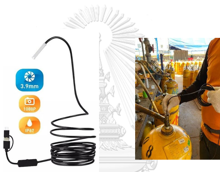
รูปที่ 21 การใช้กล้องงู (Android Endoscope Camera) ตรวจสอบน้ำภายในถัง
