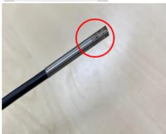
รูปที่ 38 ก๊อแงที่ถูกคลอรีนกัดกร่อน
