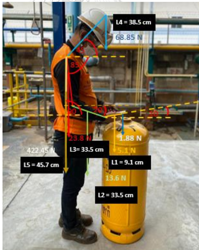
รูปที่ 34 การคำนวณค่าแรงกดอัดที่หลังส่วนล่างด้วยการใช้กล้อง
