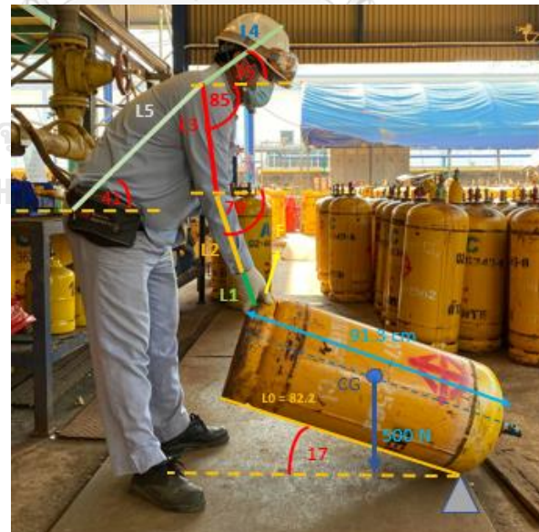
รูปที่ 16 ท่ายกระยะที่ 2 ยกโดยถึงท่ามุมกับพื้น 15-25 องศา
