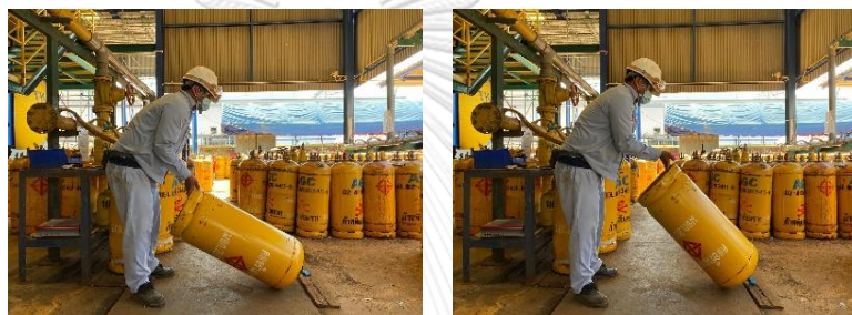
ขั้นตอนที่ 2 ยกฐานของถังให้สูงขึ้นจนถึงเอียงและคว่ำลง โดยให้ตำแหน่งของวาล์วจ่ายบริเวณหัวถังสัมผัสถึงพื้น
