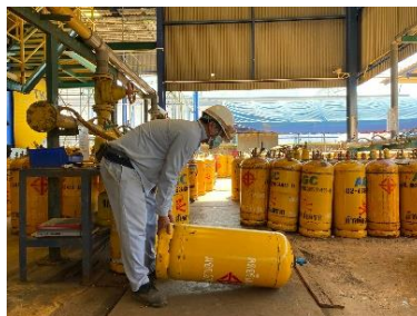
ขั้นตอนที่ 1 นำถังคลอรีนวางในแนวราบกับพื้นและเริ่มยกถังคลอรีนขึ้น
