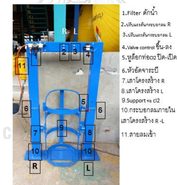
รูปที่ 26 เครื่องยกถังคลอรีนแบบกระบอกลม
