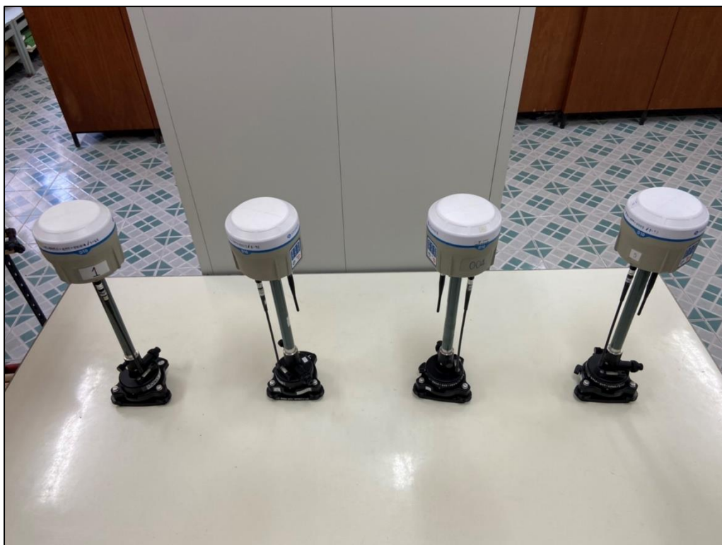
รูปที่ 2 เครื่องมือสำรวจรังวัดดาวเทียมระบบ GNSS ยี่ห้อ Stonex รุ่น S10
