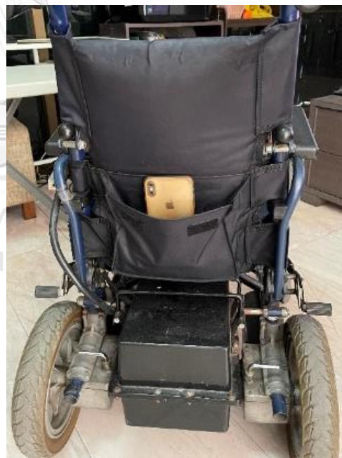
รูปที่ 45 ติดกล้องสมาร์ทโฟนไว้ด้านหลังเก้าอี้รถเข็นไฟฟ้า
