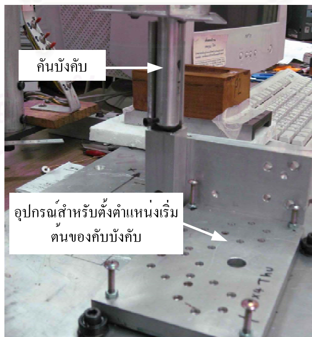
รูปที่ 6.1 การตั้งตำแหน่งเริ่มต้นของคันบังคับ
