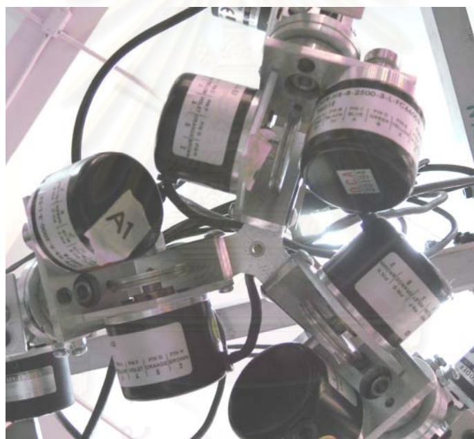
รูปที่ ก.4 แสดงตำแหน่งที่ติดตั้งอุปกรณ์วัดมุมของข้อแบบเลื่อน
