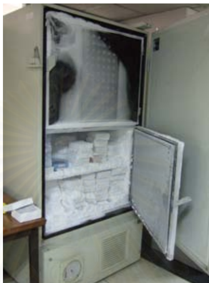
รูปที่ 52 แสดงตู้ความเย็น เก็บชิ้นเนื้อ ที่อุณหภูมิต่ำ -80^{\circ}\text{C}
