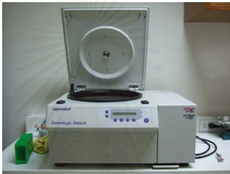
รูปที่ 54 แสดงเครื่องปั่น centrifuge ที่ใช้ในการสกัด RNA
