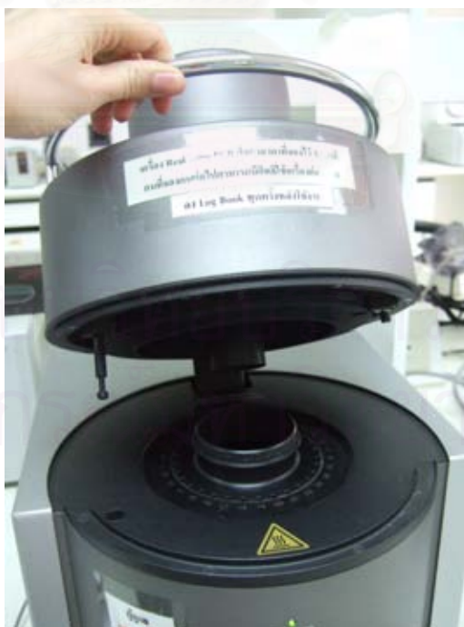
รูปที่ 59 แสดงเครื่อง Real time PCR รุ่น The LightCycler (Roche Molecular Biochemicals)
