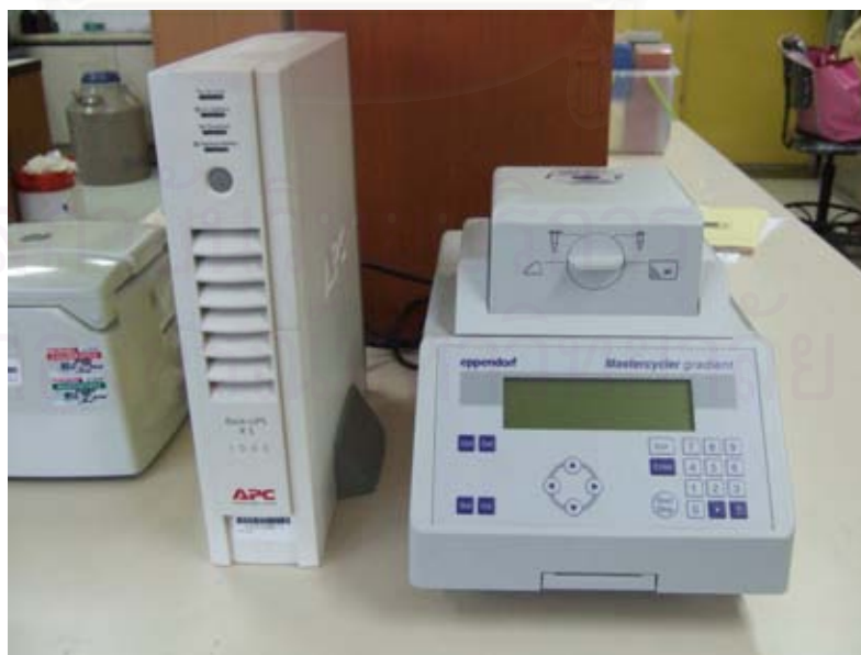
รูปที่ 57 แสดงอุปกรณ์เครื่อง Thermal Cycle ที่ใช้ในงานวิจัยนี้
