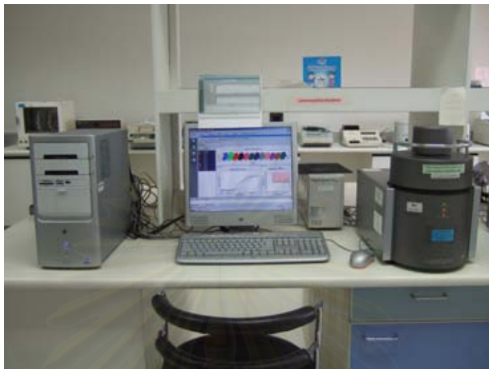
รูปที่ 37 แสดงเครื่อง Real Time PCR รุ่น LightCycler (Roche Molecular Biochemicals) ต่อกับเครื่องคอมพิวเตอร์สำหรับประมวลผลที่ใช้ในการศึกษาวิจัยนี้
