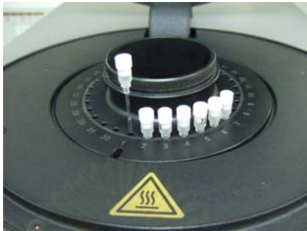
รูปที่ 60 แสดงช่องใส่สารตัวอย่างที่ใช้ในการทำ Real time PCR ด้วยเครื่อง The lightCycle
