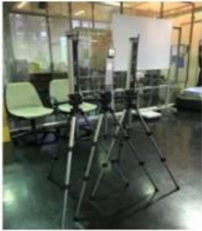
รูปที่ 13 เครื่องวัดความสามารถในการวิ่ง ยี่ห้อ Swift Speed Light timing & training systems (Australia)
