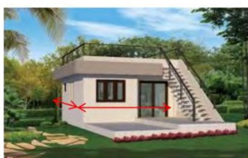
- วัดตามขนาดของ ตัวอาคาร ไม่ต้องวัด บริเวณบันไดและ ชานหน้าบ้าน
