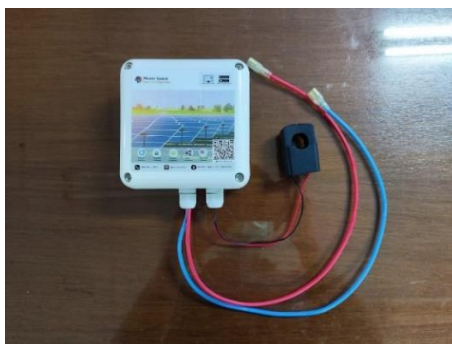
รูปที่ 10 Data Logger วัดค่าทางไฟฟ้า
