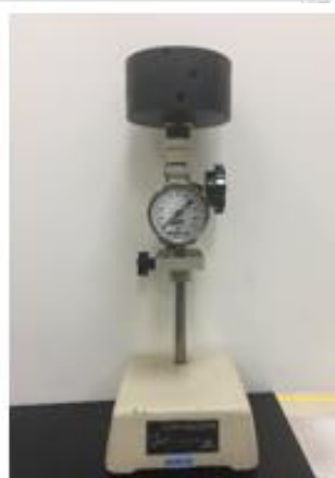
รูปที่ 3.6 การทดสอบความแข็งด้วยเครื่อง Durometer hardness ชนิด Shore D ของบริษัท Instron
