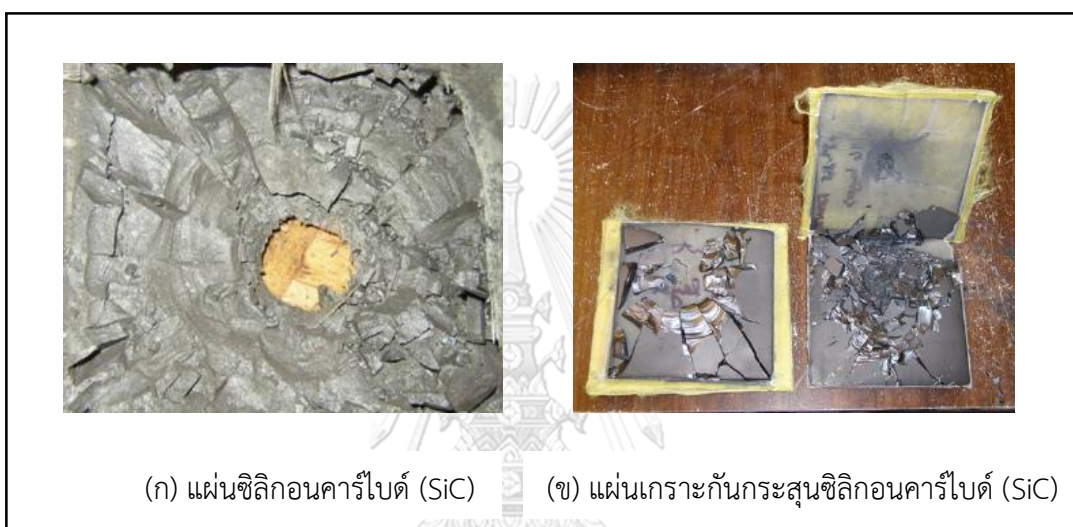
รูปที่ 2.3 ลักษณะความเสียหายของวัสดุเซรามิกประยุกต์ใช้เป็นเกราะกันกระสุน [2]
