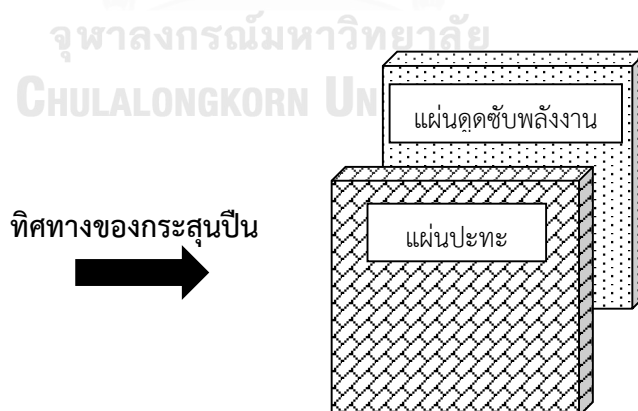
รูปที่ 3.7 ทิศทางการปะทะของกระสุนปืนของวัสดุคอมโพสิตโดยใช้เบนซอกซาซีนเรซินเสริมแรงด้วยเส้นใย
