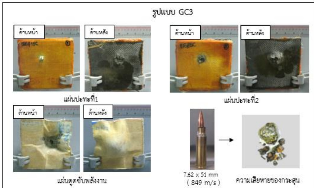
รูปที่ 4.15 ความเสียหายของกระสุนปืนและวัสดุคอมพอลิท์สำหรับประยุกต์ใช้เป็นเกราะกันกระสุนของรูปแบบ GC3 ในการจัดลำดับชั้นแผ่นปะทะ
