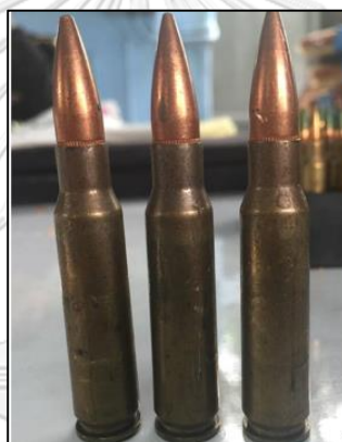
รูปที่ 3.8 อุปกรณ์ในการทดสอบยิงชิ้นงานเกราะกันกระสุนตามมาตรฐาน NIJ-0101.06 ที่ระดับภัยคุกคามระดับ 3
