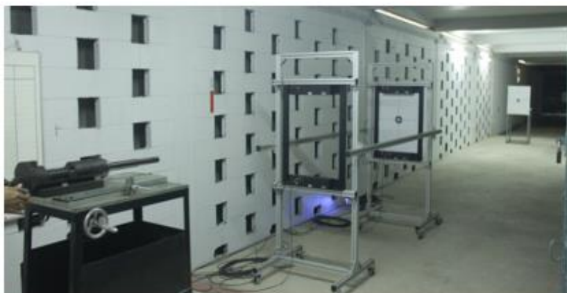
รูปที่ 3.8 อุปกรณ์ในการทดสอบยิงชิ้นงานเกราะกันกระสุนตามมาตรฐาน NIJ-0101.06 ที่ระดับภัยคุกคามระดับ 3
