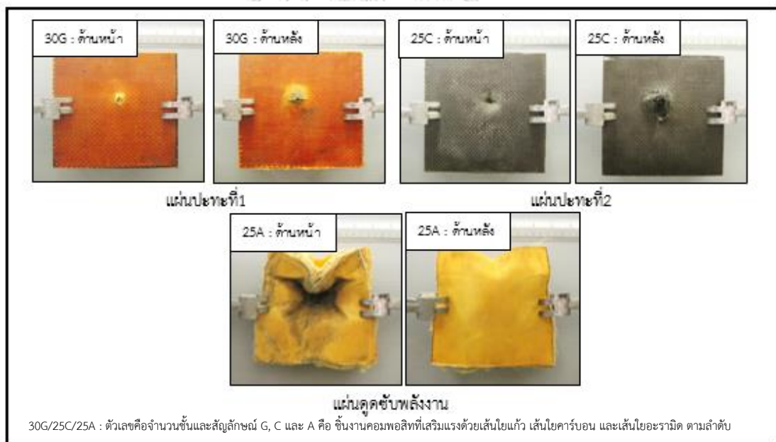
รูปที่ 4.6 ความเสียหายของวัสดุคอมพอลิท์สำหรับประยุกต์ใช้เป็นเกราะกันกระสุน ทดสอบโดยกระสุนปืนขนาด 7.62 มม. ที่ความเร็ว 844 เมตร/วินาที
