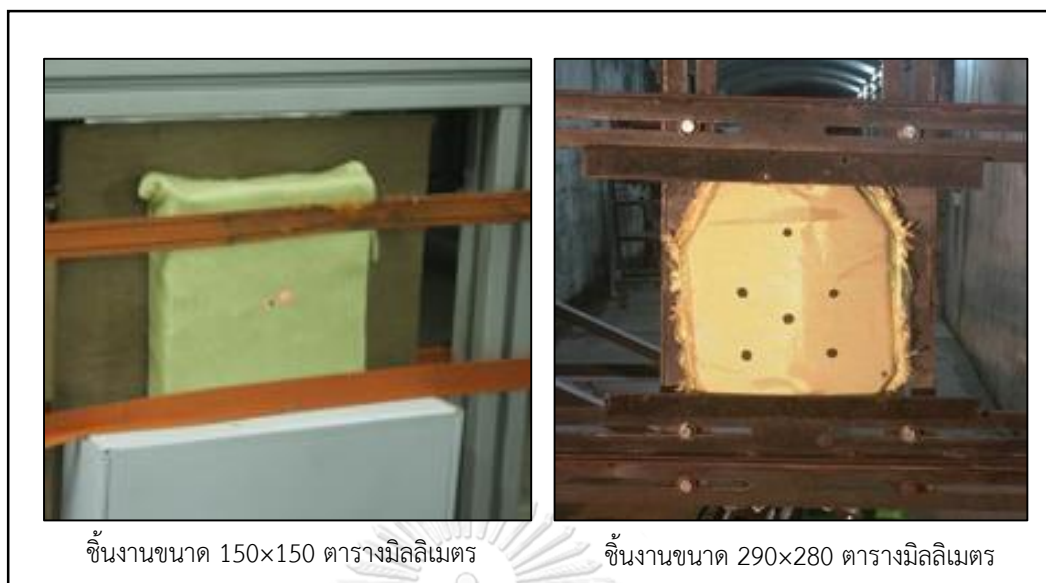
รูปที่ 3.10 ขนาดชิ้นงานและตำแหน่งในการทดสอบยิงชิ้นงานเกราะกันกระสุนที่ ตามมาตรฐาน NIJ-0101.06 ที่ระดับภัยคุกคามระดับ 3
