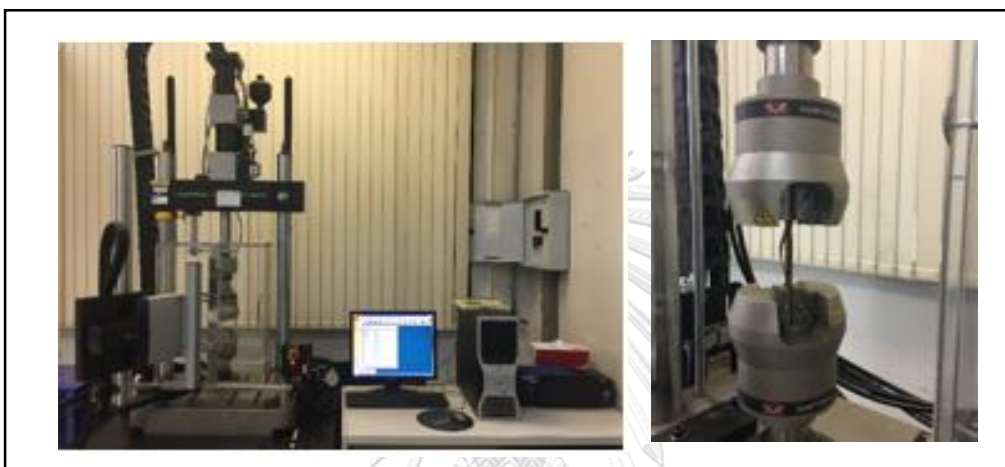
รูปที่ 3.3 การทดสอบความต้านทานแรงดึงด้วยเครื่อง Universal testing machine ของบริษัท Instron รุ่น 8872
