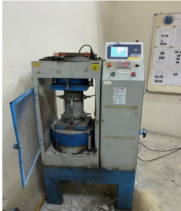
รูปที่ 46 การทดสอบค่าโมดูลัสยืดหยุ่นของคอนกรีต
