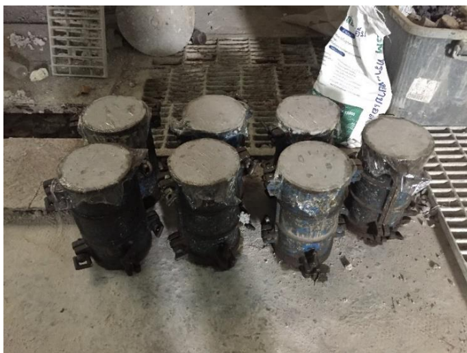
รูปที่ 39 ตัวอย่างคอนกรีตหลังผสมเสร็จ
