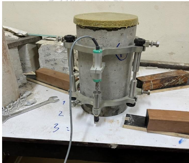
รูปที่ 45 การติดตั้งเครื่องมือวัดระยะการหดตัวของคอนกรีต
