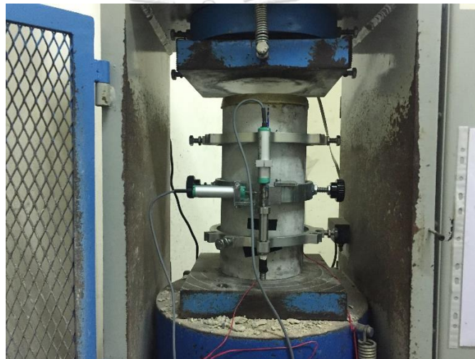
รูปที่ 43 การติดตั้งอุปกรณ์วัดระยะการหดตัวของคอนกรีตเพื่อทดสอบหาค่าโมดูลัสยืดหยุ่น
