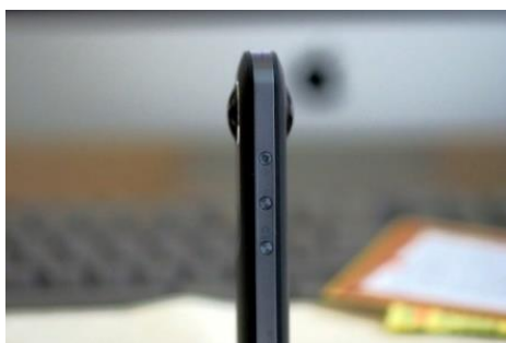
ภาพ 2.3 กล้องรอบทิศทางบางรุ่นมีเลนส์มุมกว้างที่ด้านหน้าและด้านหลัง เพื่ออำนวยความสะดวกในการบันทึกวีดิทัศน์แบบ 360 องศา
