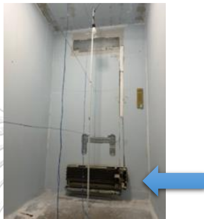
ภาพที่ 31 เครื่องปรับอากาศ ณ ระดับ A (+0.15 ม.) เหนือข้อเท้า โดยวัดจากขอบล่างเครื่อง
