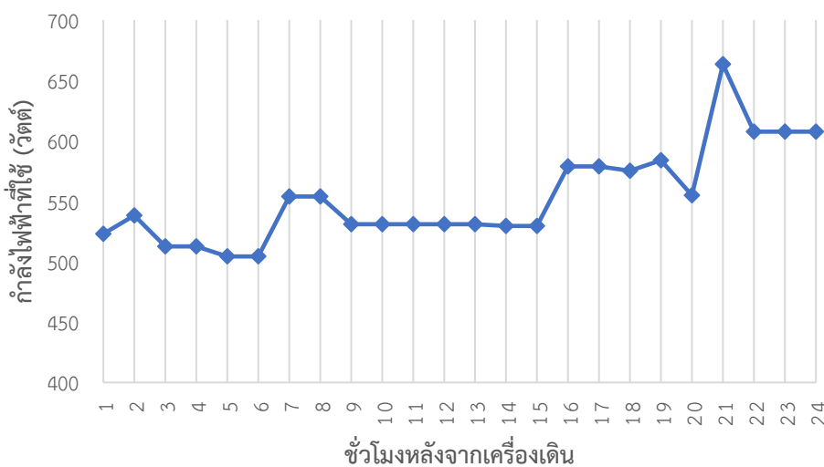
ภาพที่ 45 ค่ากำลังไฟฟ้าของเครื่องปรับอากาศแยกส่วนแบบไร้พัดลม
