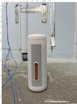
ภาพที่ 63 เครื่องลดความชื้น (Dehumidifier) ถูกนำมาติดตั้งในห้องทดสอบ
