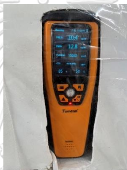
ภาพที่ 28 เครื่องตรวจสอบคุณภาพอากาศ (Air Quality Monitor) ยี่ห้อ Elitech รุ่น TEMTOP M2000C
