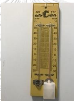
ภาพที่ 25 เทอร์โมมิเตอร์ เปียก-แห้ง ยี่ห้อ (Dry-Wet) เป็นทำจากไม้
