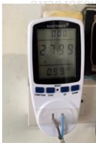
ภาพที่ 26 เครื่องมิเตอร์วัดกำลังวัตต์ดิจิทัล ยี่ห้อ SINOTIMER รุ่น DDS108 และแคลมป์มิเตอร์ ยี่ห้อ NPV รุ่น 3266TB
