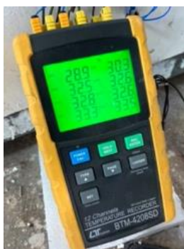
ภาพที่ 24 เครื่องวัดอุณหภูมิ 12 ช่อง ยี่ห้อ Lutron รุ่น BTM-4208SD
