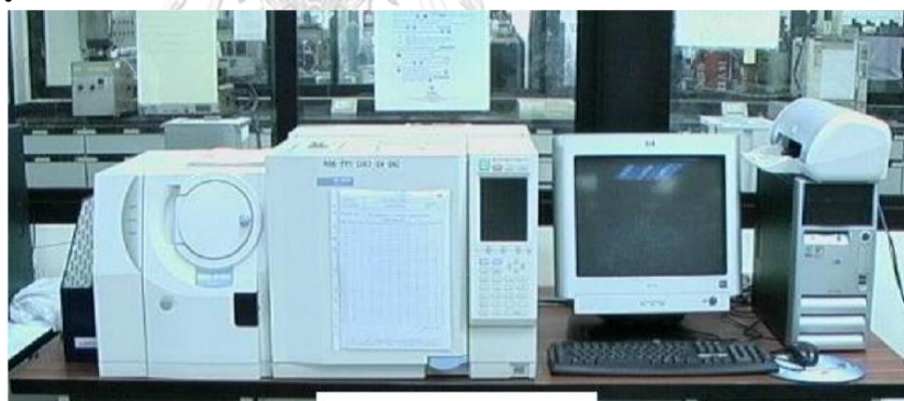
รูปที่ 3. 6 เครื่องแก๊สโครมาโทกราฟี-แมสสเปกโตรเมตรี (gas chromatograph-mass spectrometry)
