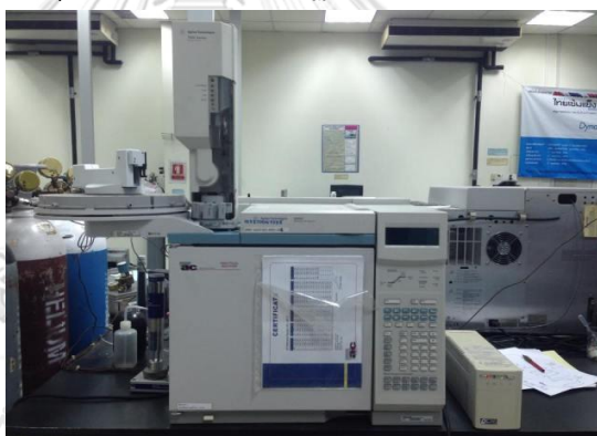
รูปที่ 3. 7 เครื่องดิสทิลเลชันแก๊สโครมาโทกราฟี (distillation gas chromatograph)
