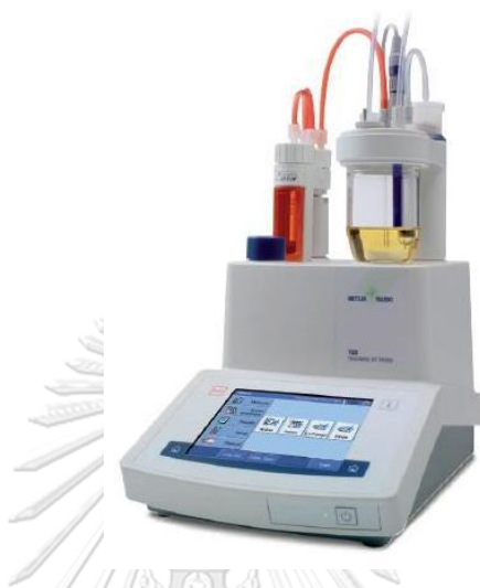
รูปที่ 3. 8 เครื่องวิเคราะห์หาปริมาณน้ำในน้ำมันดิบชีวภาพ (Karl-Fischer titrator)
