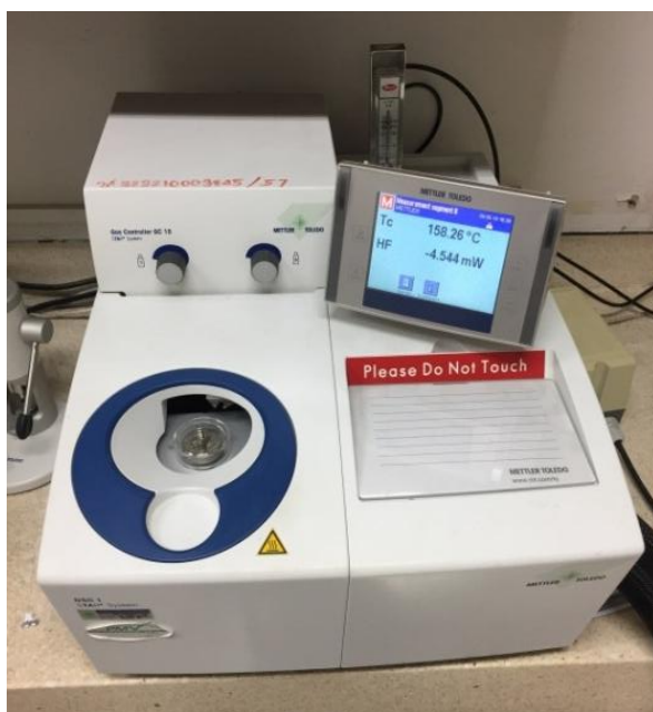
รูปที่ 3.12 เครื่องดีพีเพอเรนเชียลสแกนนิ่งแคลอริมิเตอร์
