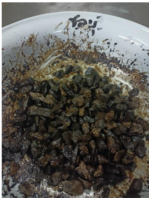
รูปที่ 54 ผสมแคทไอออนิกแอสฟัลต์อิมัลชันกับยางพาราที่ 10%
