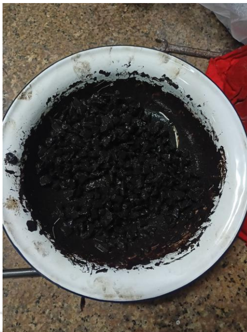
รูปที่ 35 แอสฟัลต์ครอบคลุมมวลรวมทั้งหมด
