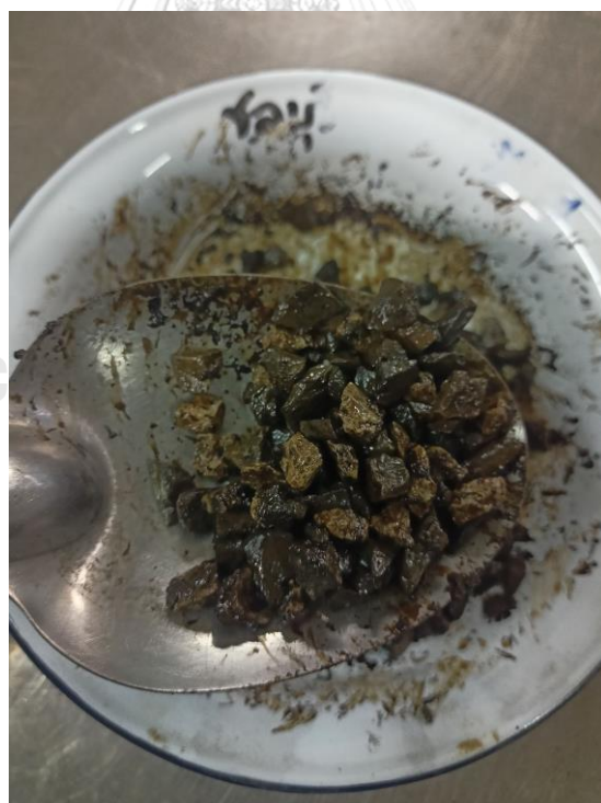
รูปที่ 55 ผสมแคทไอออนิกแอสฟัลต์อิมัลชันกับยางพาราที่ 10%
