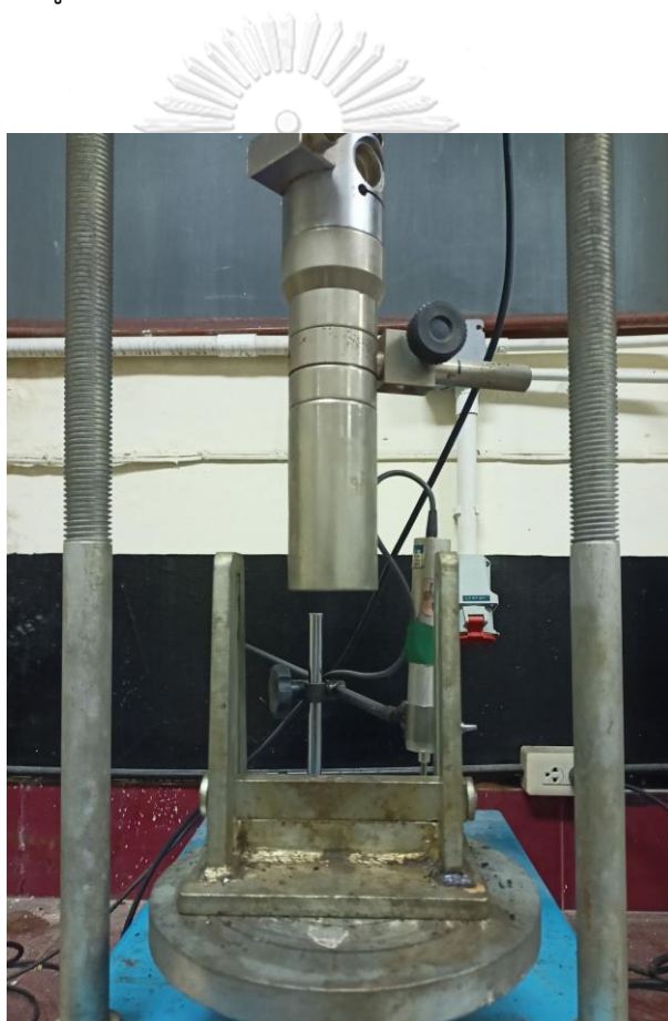
รูปที่ 30 Loading Strip สำหรับทดสอบ ITS
