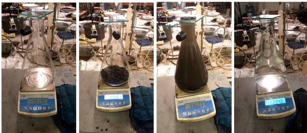
รูปที่ 10 แสดงถึงการใช้ขวด Pycnometer ในการหาค่า Maximum specific gravity ของ HMA
