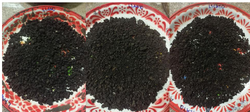
รูปที่ 72 การครอบคลุมของแอสฟัลต์ของตัวอย่าง Loose sample ของหินปูนชลบุรี
