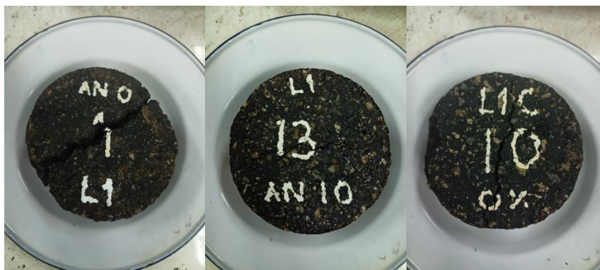
รูปที่ 69 การครอบคลุมของแอสฟัลต์ในก้อนตัวอย่างของหินปูนชลบุรี
