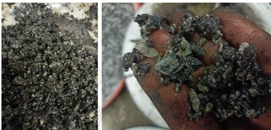
รูปที่ 63 ตัวอย่างการผสมหินปูนชลบุรีที่มีการเติมน้ำยางพาราในแคทไอออนิก
