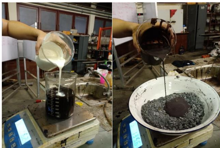
รูปที่ 45 การผสมน้ำยางพาราลงในแอสฟัลต์อิมัลชัน
