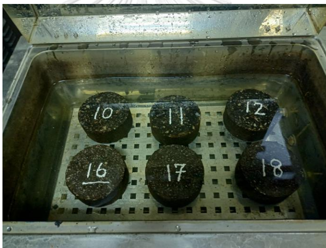
รูปที่ 29 ก้อนตัวอย่างสำหรับการทดสอบความเสียหายเนื่องจากความชื้นในสถานะเปียก
