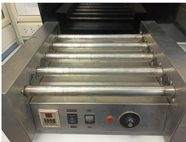
รูปที่ 39 เครื่องกลิ้งขวดสำหรับการทดสอบ RBT
