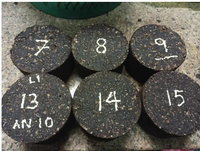
รูปที่ 28 ก้อนตัวอย่างสำหรับการทดสอบความเสียหายเนื่องจากความชื้นในสถานะแห้ง
