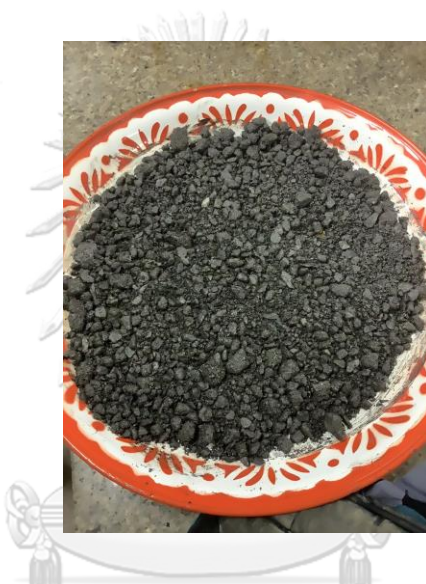
รูปที่ 9 แสดงถึงสภาพที่เป็นเม็ดกระจัดกระจายของ HMA (Rice sample of HMA)
