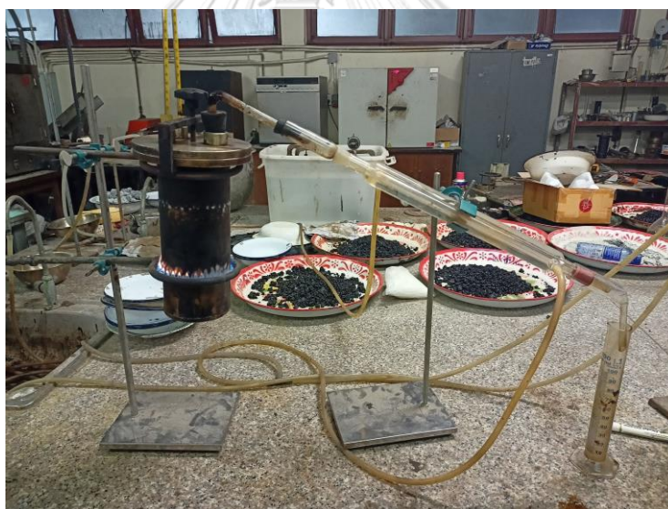
รูปที่ 44 การทดสอบหาปริมาณกากที่เหลือจากการระเหย
