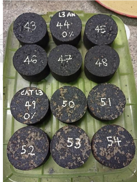
รูปที่ 50 ก้อนตัวอย่างสำหรับนำไปทดสอบ ITS
