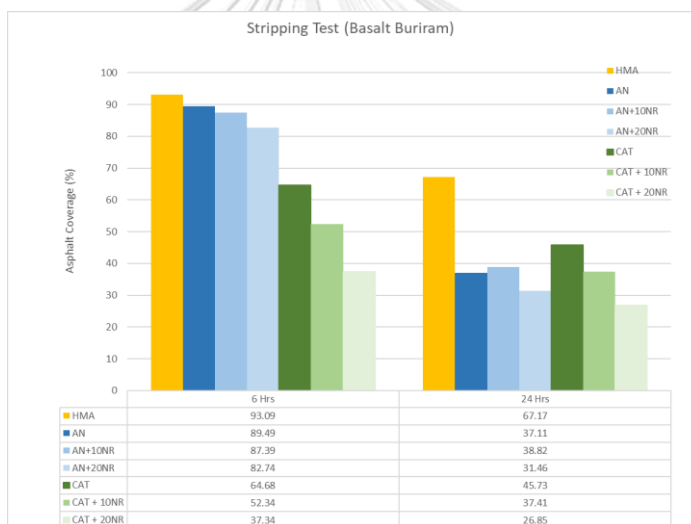
รูปที่ 62 เปอร์เซ็นต์ความครอบคลุมแอสฟัลต์บนผิวหินบะซอลต์บุรีรัมย์
