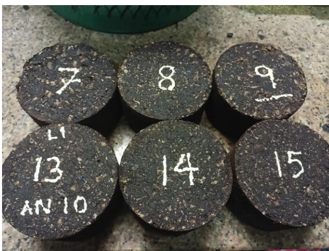
รูปที่ 51 ก้อนตัวอย่างสำหรับการทดสอบความเสียหายเนื่องจากความชื้นในสภาวะแห้ง
