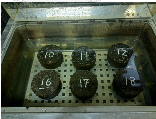
รูปที่ 52 ก้อนตัวอย่างสำหรับการทดสอบความเสียหายเนื่องจากความชื้นในสภาวะเปียก
