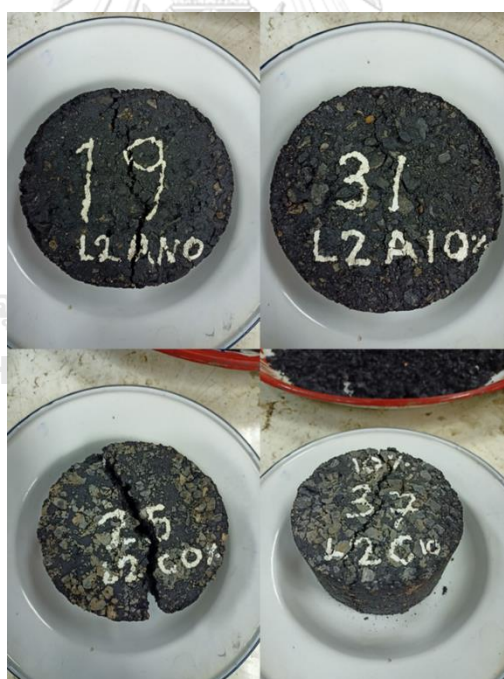
รูปที่ 70 การครอบคลุมของแอสฟัลต์ในก้อนตัวอย่างของหินปูนสระบุรี
