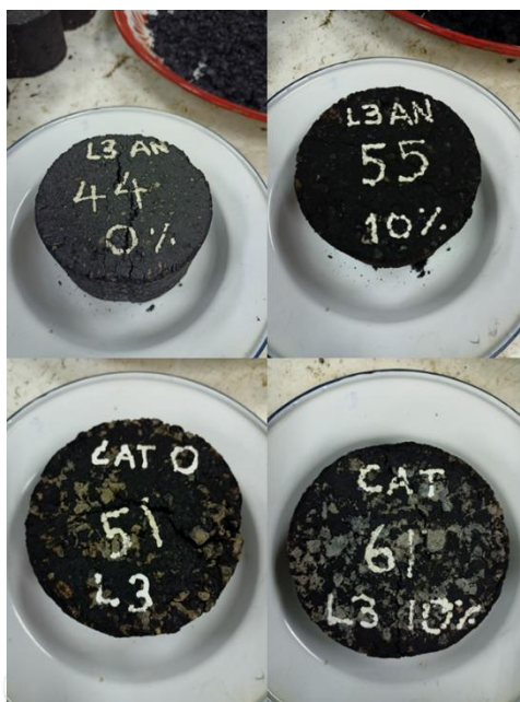
รูปที่ 71 การครอบคลุมของแอสฟัลต์ในก้อนตัวอย่างของหินบะซอลต์บุรีรัมย์
