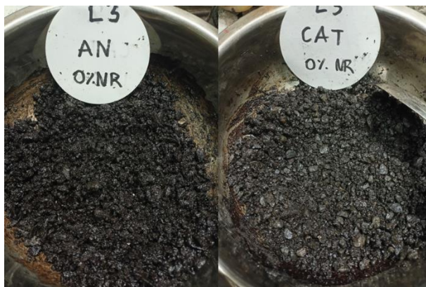
รูปที่ 46 ตัวอย่างที่ผสมก่อนกำการบดอัด
