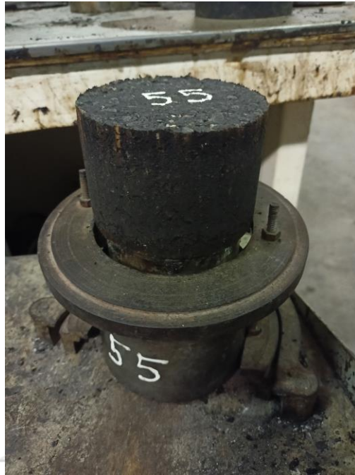
รูปที่ 49 นำก้อนตัวอย่างออกจากโมลหลังจากอบ 2 วัน
