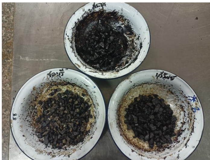
รูปที่ 56 การเปรียบเทียบระหว่างหินสามชนิด ของการนำแคทไอออนิกผสมกับน้ำยางพาราที่ 10% โดยที่งานด้านบนคือหินสระบุรี ด้านซ้ายคือหินชลบุรี ด้านขวาคือหินบุรีรัมย์
