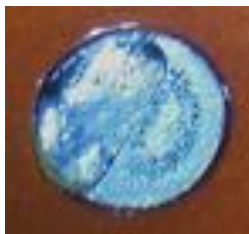
รูปที่ 1.11 โลหะบัดกรีโป่งพอง
