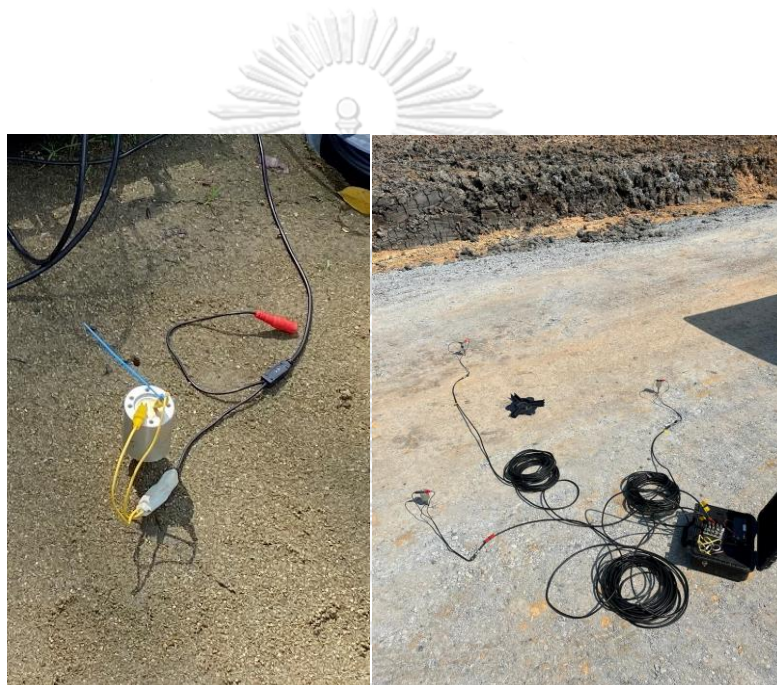
รูปที่ 11 เครื่องมือตรวจวัดคลื่นขนาดเล็กที่ผิว (Microtremor)
