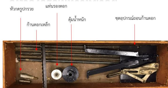
รูปที่ 27 รายละเอียดของเครื่องมือ Dynamic Probing Light
