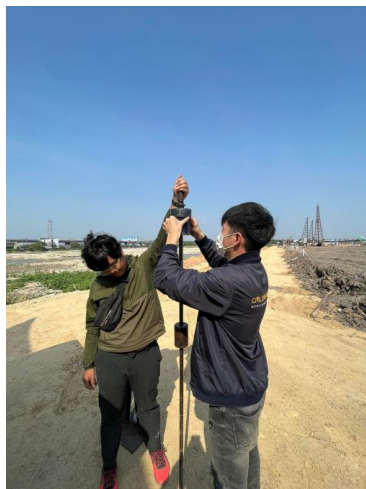
รูปที่ 12 เครื่องมือการตอกหยั่งแบบเบา
