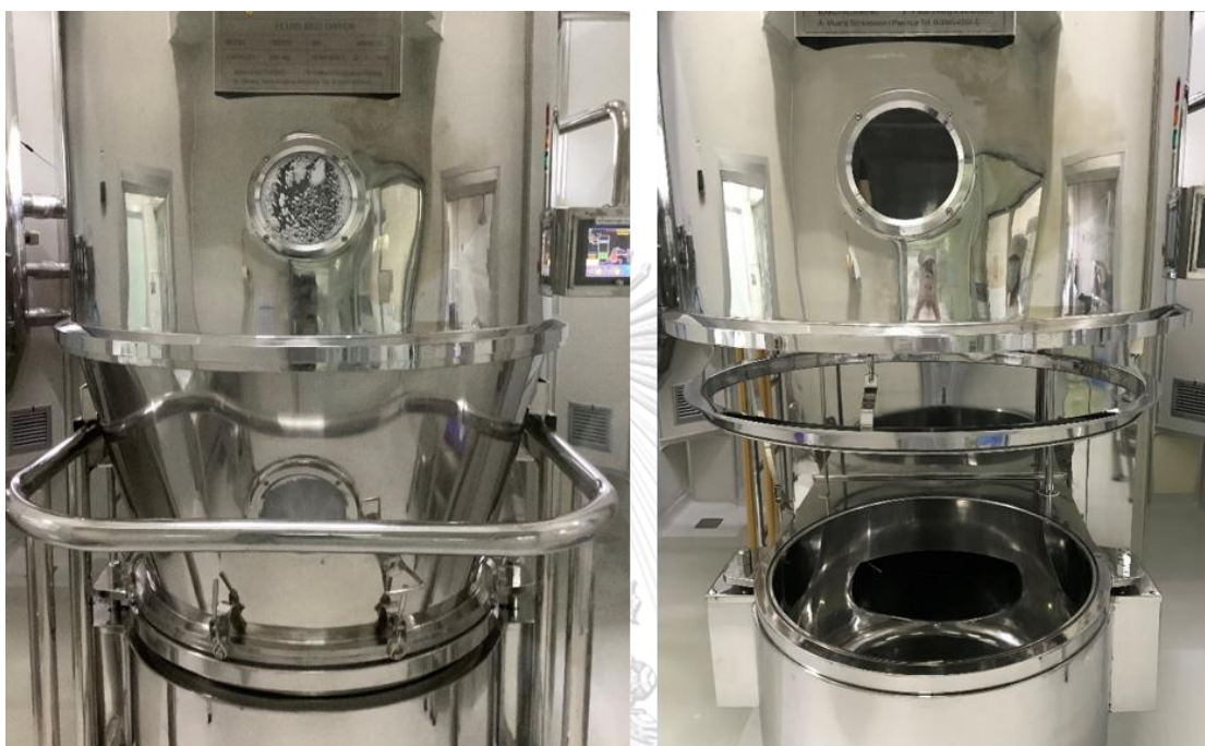
รูปที่ 1-3 เครื่องฟลูอิดเบดขณะทำงาน(ซ้าย) และเครื่องขณะถอดชิ้นส่วนเพื่อทำความสะอาด (ขวา)
