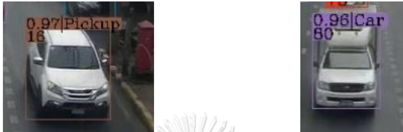
รูปที่ 22 แสดงความผิดพลาดในการนับยานพาหนะที่มีลักษณะคล้ายคลึงทั้งรถยนต์และรถกระบะ
