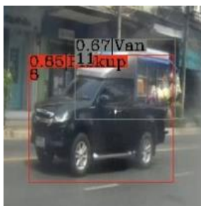
รูปที่ 18 โมเดลมีการตรวจจับบางส่วนของรถกระบะเป็นรถตู้
