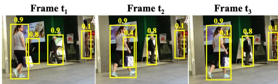
รูปที่ 3 ผลจากการบดบังที่มีผลต่อความเชื่อมั่นของ object detector [14]
