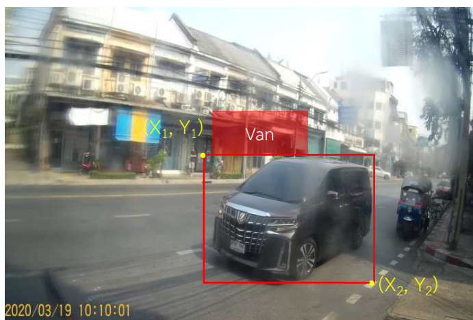
รูปที่ 8 พิกัดของ Bounding box ที่ถูกส่งออกจาก Vehicle detection
