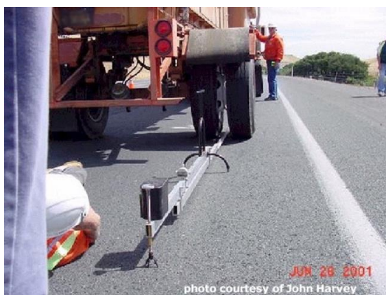
รูปที่ 5 การทดสอบการแอ่นตัวของถนนโดยใช้เครื่องมือ Benkelman Beam
