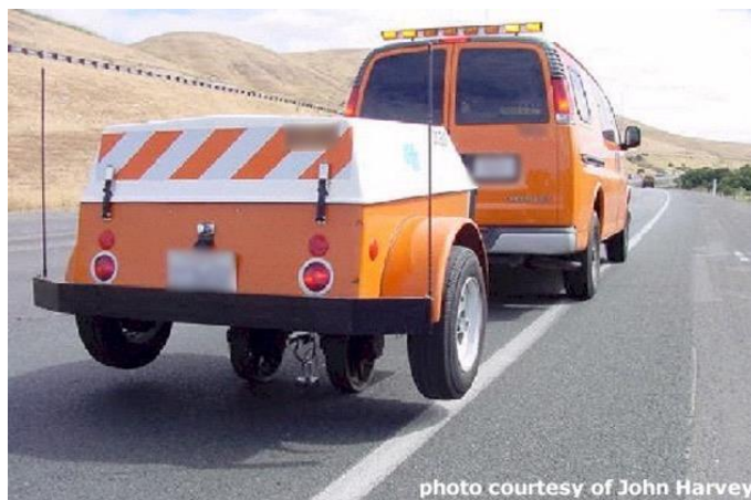
รูปที่ 6 การทดสอบการแอ่นตัวของถนนโดยใช้เครื่องมือ Dynaflect
