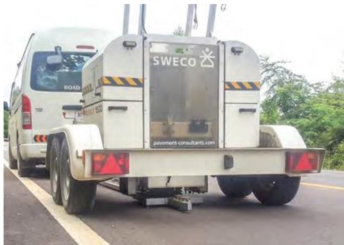
รูปที่ 7 การทดสอบการแอ่นตัวโดยใช้เครื่องมือ Falling Weight Deflectometer
