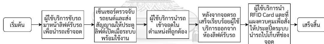
รูปที่ 3.8 กระบวนการนำรถเข้าจอตกรถในระบบจอตกรถอัตโนมัติ
