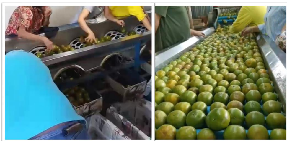
รูปภาพที่ 28 เครื่องคัดขนาดแบบสั่งทำ 2 รูปแบบ ที่มา: กลุ่มเกษตรกรรายใหญ่ส้มโชกุนอำเภอเบตง (2563)
