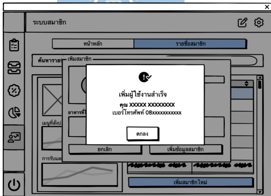
รูปที่ 4-49: ต้นแบบเว็บแอปพลิเคชันแบบหยาบด้วยเครื่องมือ Balsamiq แสดงหน้าจอ Popup เพิ่มสมาชิกสำเร็จ
