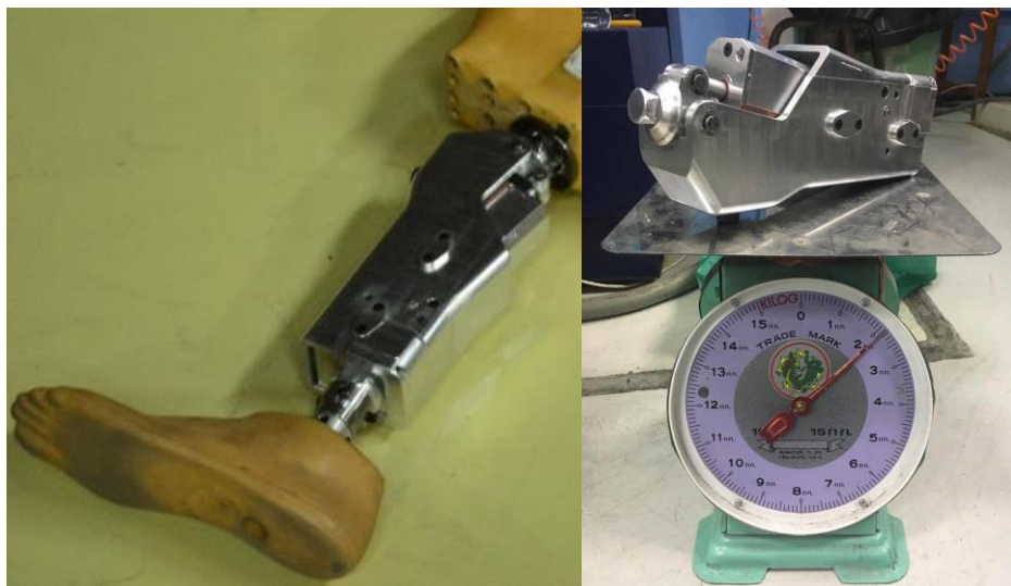
รูปที่ 5.13 ข้อเข้าเทียมระบบไฮดรอลิกที่ประกอบเรียบร้อยแล้ว
