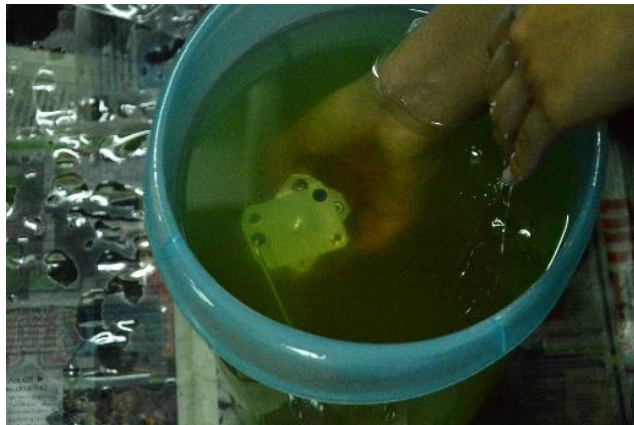
รูปที่ 5.4 ขั้นตอนการเติมน้ำมันเข้าไปในระบบไฮดรอลิก
