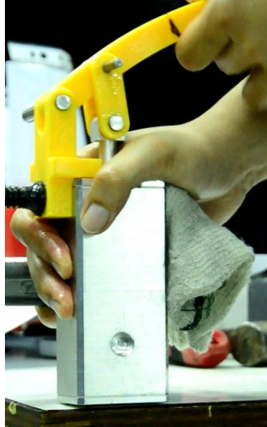
รูปที่ 5.8 ทดสอบการทำงานของวาล์วควบคุมทิศทางการไหล
