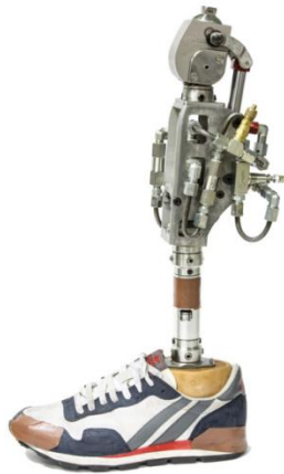
รูปที่ 3.1 ต้นแบบข้อเข่าเทียมไฮดรอลิกที่ได้จากโครงการการออกแบบและสร้างเข่าเทียมไฮดรอลิก สำหรับผู้พิการขาขาดเหนือเข่าที่แข็งแรง ปีที่ 1
