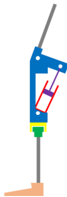
รูปที่ 3.3 โครงสร้างของข้อเข้าเทียมระบบไฮดรอลิกที่ออกแบบ
