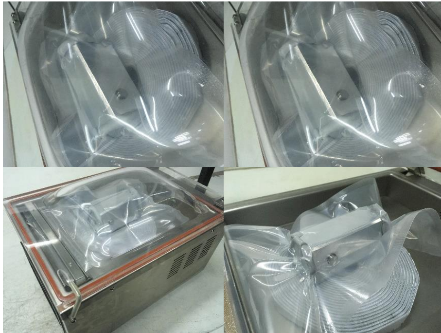
รูปที่ 5.3 ขั้นตอนการดูดอากาศด้วยเครื่อง Vacuum
