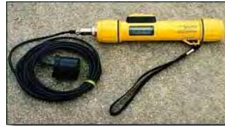
เครื่องตรวจวัดความลึกน้ำบันทึกเป็นรายชั่วโมง (Echosounder)
