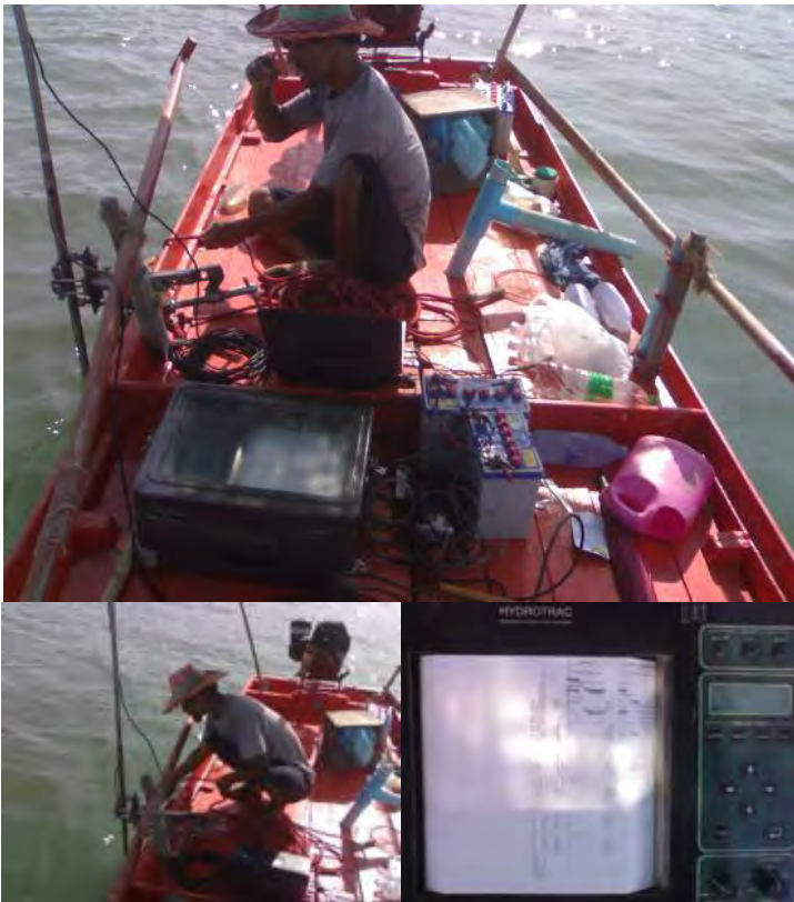
การติดตั้งเครื่องมือสำรวจระดับความลึกของคลองและ การตรวจสอบความถูกต้องของค่าความลึกที่อ่านจากเครื่องหยั่งน้ำ
