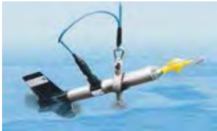
เครื่องตรวจวัดข้อมูลกระแสน้ำ (Valeport model 106)
