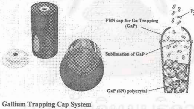
รูปที่ 2.4 ภาพโครงสร้างของ Ga-trapping cap [12]
