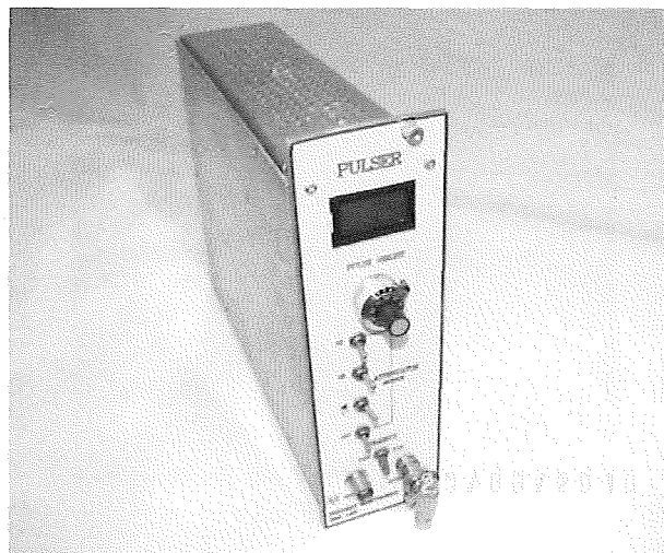
รูปที่ 2 แสดงเครื่องกำเนิดสัญญาณพัลส์นิวเคลียร์ที่พัฒนาขึ้น โดยหน่วยสนับสนุนงานวิจัยภาควิชานิวเคลียร์เทคโนโลยี คณะวิศวกรรมศาสตร์ จุฬาลงกรณ์มหาวิทยาลัย
