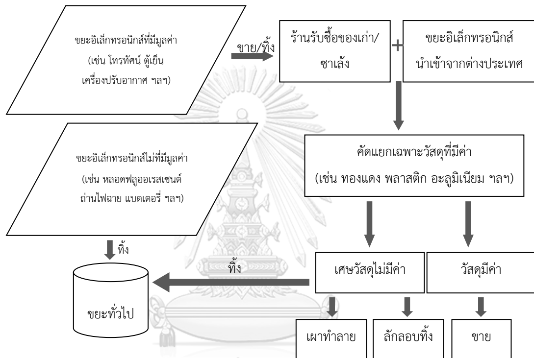
รูปที่ 2.1 การจัดการขยะอิเล็กทรอนิกส์ในประเทศไทย (ที่มา: ดัดแปลงจากกรมควบคุมมลพิษ, 2558)
