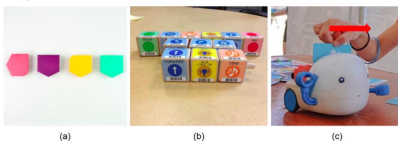
ภาพที่ 16 ภาพตัวอย่างชุดอุปกรณ์แบบกายภาพ (Physical Kits) ที่มีแยกส่วนบล็อกตัวต่อและหุ่นยนต์ออกจากกัน ในด้านซ้าย (a) ชื่อว่า Cubetto ในส่วนตรงกลาง (b) เป็นส่วนบล็อกตัวต่อของหุ่นยนต์ชื่อว่า Kibo และ ในด้านขวา (c) ชื่อว่า Plobot 15
