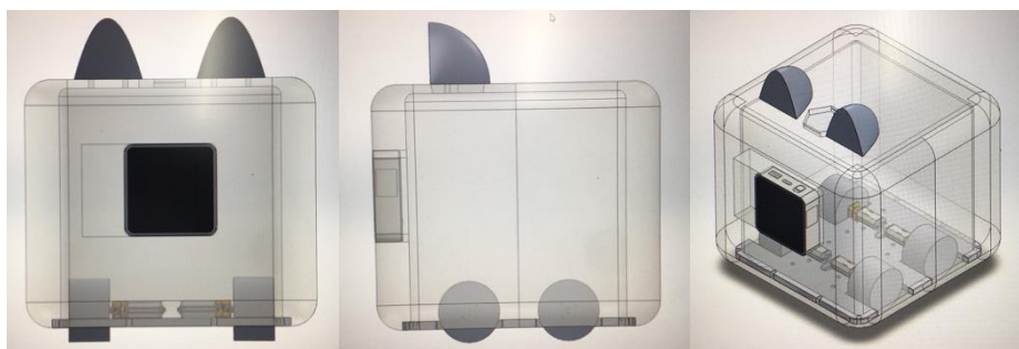
ภาพที่ 34 โครงร่างฮาร์ดแวร์สอนเขียนโปรแกรมแบบตัวต่อรูปแบบหุ่นยนต์สี่ล้อสร้างขึ้นด้วยโปรแกรม Solidworks
