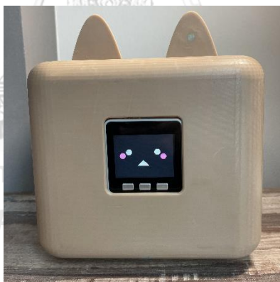
ภาพที่ 53 TAMACODEJI (ฮาร์ดแวร์สอนเขียนโปรแกรมแบบตัวต่อในรูปแบบหุ่นยนต์สัตว์เลี้ยง)
