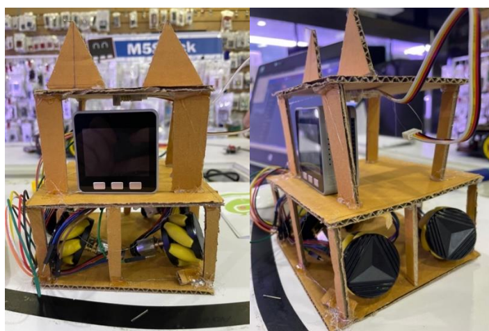
ภาพที่ 33 โครงร่างต้นแบบฮาร์ดแวร์สอนเขียนโปรแกรมแบบตัวต่อรูปแบบหุ่นยนต์สัตว์เลี้ยง
