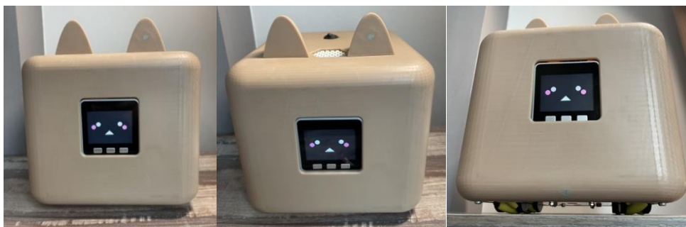
ภาพที่ 35 ต้นแบบของฮาร์ดแวร์สอนเขียนโปรแกรมแบบตัวต่อรูปแบบหุ่นยนต์สัตว์เลี้ยงที่เสร็จสมบูรณ์
