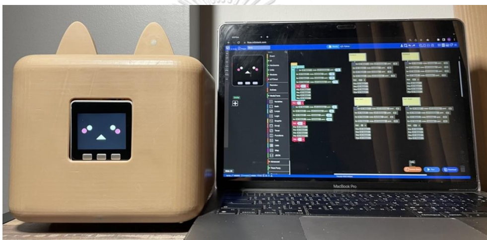
ภาพที่ 36 การเชื่อมต่อฮาร์ดแวร์สอนเขียนโปรแกรมรูปแบบหุ่นยนต์สัตว์เลี้ยงเข้ากับคอมพิวเตอร์
