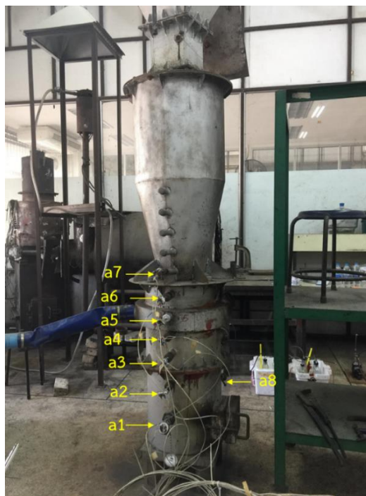
รูปที่ 5.17 จุดเก็บอุณหภูมิในเตาแก๊สซีฟเออร์แบบไหลลง
