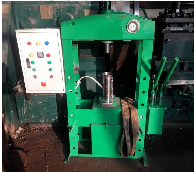
รูปที่ 4.1 เครื่องอัดแท่งเชื้อเพลิงแบบใช้กระบอกระบบไฮดรอลิก
