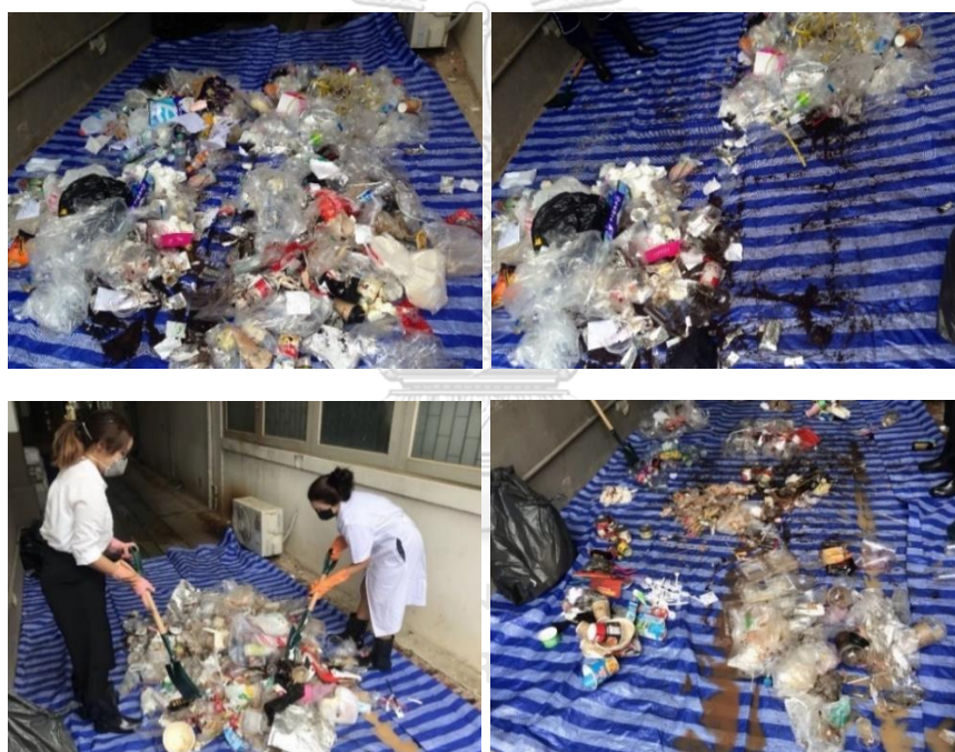
รูปที่ 4.4 การเก็บรวบรวมขยะด้วยวิธีการ Quartering
