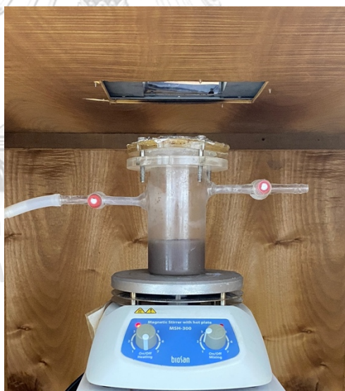
ภาพที่ 3.2 เครื่องปฏิกรณ์ผลิตไฮโดรเจนในตู้ป้องกันแสงยูวี
