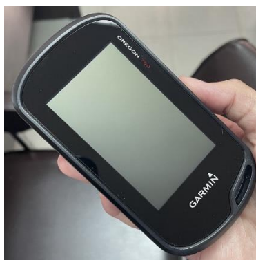
ภาพที่ 9 เครื่องรับสัญญาณดาวเทียม GNSS แบบมือถือ
